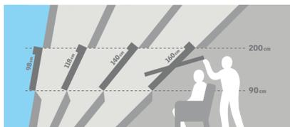
Las ventanas giratorias permiten la colocación de muebles debajo de la ventana sin obstruir su funcionamiento.
